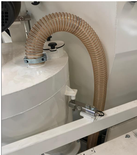
Entlüftung der Waage in den Mischer
